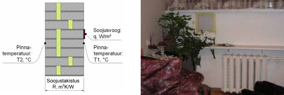
Joonis 5.2 Soojusvoo mõõtmise põhimõtteline skeem (vasakul) ja korterelamu välisseina soojustakistuse mõõtmine (paremal).
