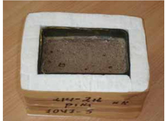
Joonis 2.9 Külmutuskeskkonna temperatuuri/ajatsükkel (EVS 814:2003) katsetatava katsekeha pinna keskel (vasakul). Silikaattellise katsekeha pärast 56 külmutus-sulatustsüklit (paremal).
