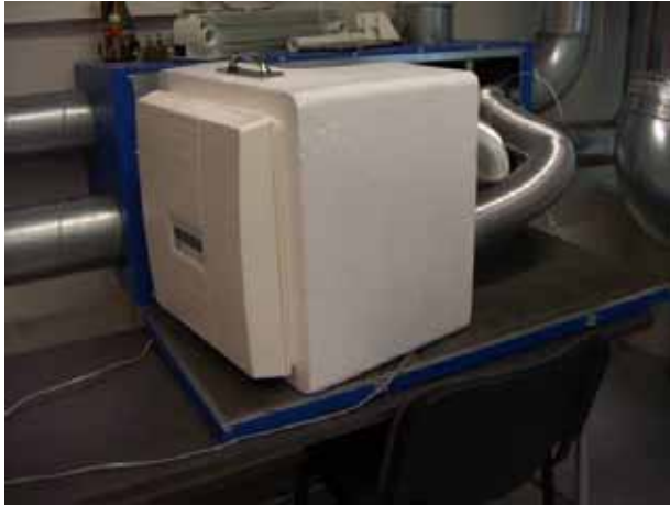
Joonis 13.16 Meltemi ruumipõhise ventilatsiooniagregaadi M-WRG katsetamine Tallinna Tehnikaülikooli laboris (vasakul) ja keraamilise soojustagastiga ruumipõhise paariseadme üks osa (paremal).
